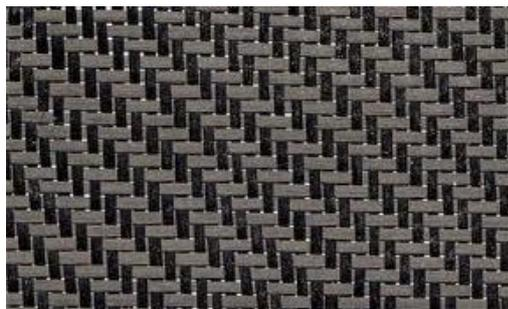
Figura 2.2 Tejido de fibras de carbón tizadas en 2 sentidos ( $0^\circ, 90^\circ$ )
