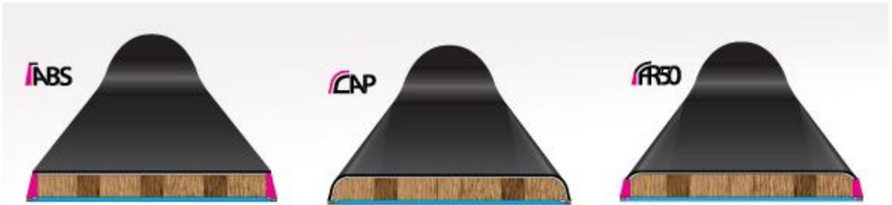
Figura 2.18 Esquema de las tres posibilidades de construcción de la tabla de esquí
