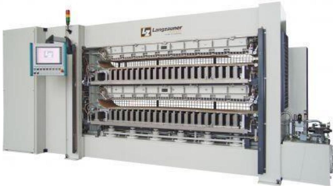
Figura 2.20 Ejemplo de una prensa industrial de esquís
