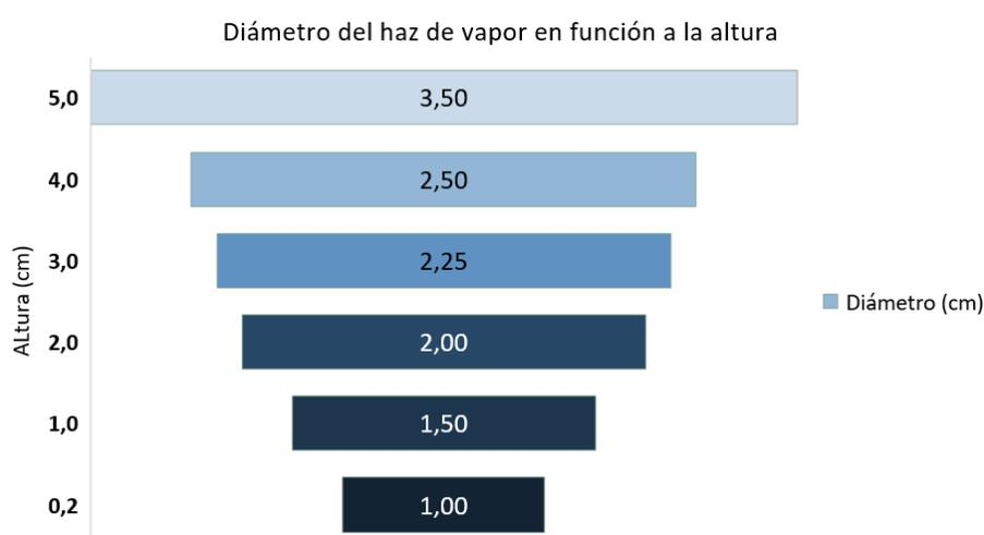
**Figura 31:** Diámetro del haz proveniente de la máquina de vapor (en cm) en función de la altura (cm).
