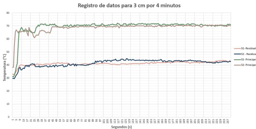
**Figura 27:** Adquisición de datos realizada a 3 cm de los sensores durante el tiempo estacionario de la máquina de vapor (4 minutos). Se pueden apreciar los datos registrados por los sensores S1 y S2 tanto en la posición principal como residual.
