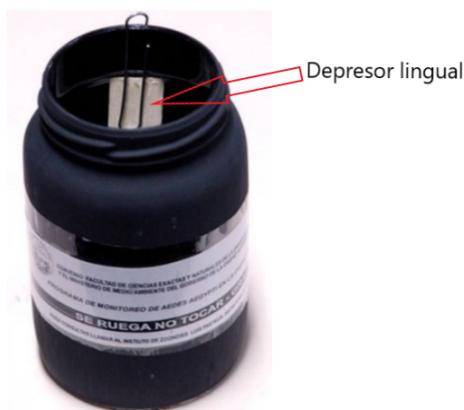
**Figura 21:** Sensor de ovipostura utilizado por el GEM. Figura adaptada de [72].
