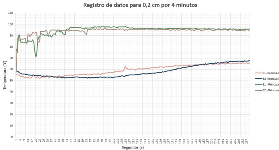
**Figura 26:** Adquisición de datos realizada a 0,2 cm de los sensores durante el tiempo estacionario de la máquina de vapor (4 minutos). Se pueden apreciar los datos registrados por los sensores S1 y S2 tanto en la posición principal como residual.
