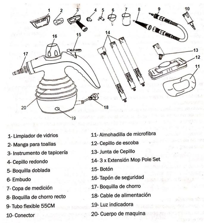
**Figura 13:** Ilustración de la máquina de vapor final, *LQLV 1050 Lusqtoff*, con los accesorios [65]
