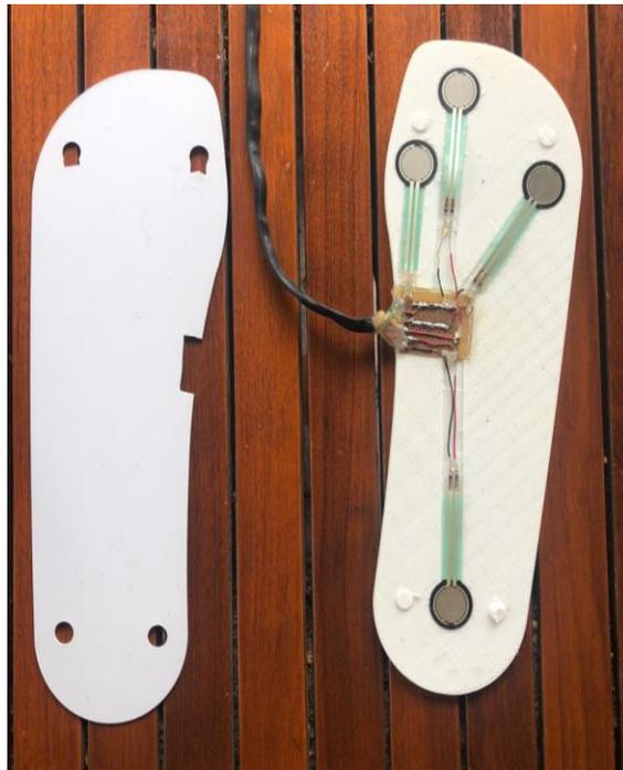
*Figura 24: A la izquierda, la tapa de la plantilla. A la derecha, los sensores soldados a la PCB y adheridos a la plantilla. El cable negro es la conexión con el Arduino, su continuación se puede ver en la figura 23.*
