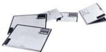
Fig. 1.5 Películas radiográficas en chasis
