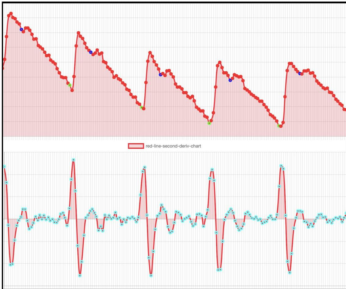
**Figura 9** - (Arriba) Captura de pantalla de pulsos obtenidos de una muestra de pletismografía de pulso. Se marca en azul la detección de onda dicrota, en verde la separación en pulsos. (Abajo) Derivada segunda de la pletismografía.
