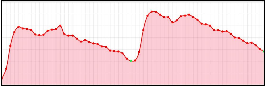
**Figura 8** - Captura de pantalla de la morfología de dos pulsos a partir de la herramienta. En verde se marca la muestra considerada por la aplicación como la división entre los dos pulsos.
