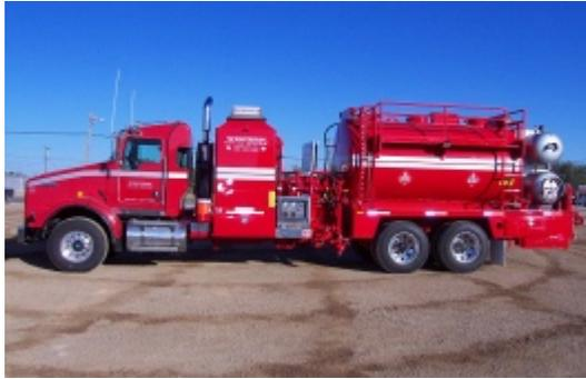
Los camiones de calentamiento típicos poseen un caudal aproximado de bombeo de 75 bbls/h. Su capacidad calorífica es de aproximadamente 7.5 millones de BTU. Deben poseer cortes de operación por alta presión o alta temperatura.
