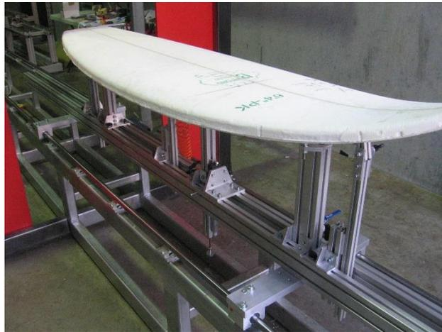
**Imagen 3-8** “Maquinaria CNC diseñada para la fabricación de tablas”
