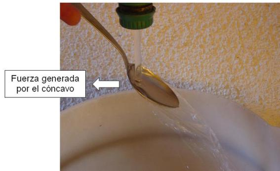
**Imagen 4-10** “Efecto de una concavidad en el flujo de agua”
