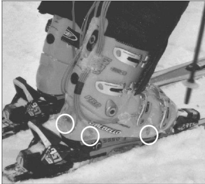
**Imagen 2-3** "Detalle de la ubicación de algunos de los extensómetros en las pruebas experimentales" (Corazza, Cobelli. 2005)
