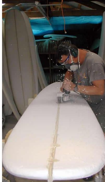
**Imagen 3-7** “Proceso manual de desbaste de material”
