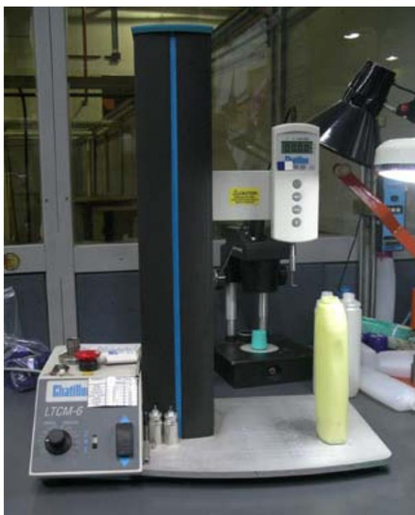
Figura 3.3-01. Dinamómetro para medición de fuerza de apertura en cerramientos para envases.
