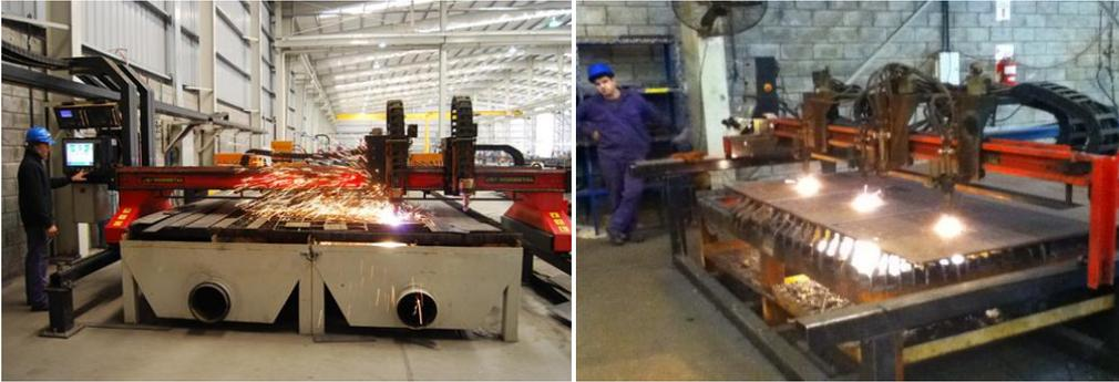
Ilustración 9: Plasma (izquierda) - Pantógrafo(Derecha)
