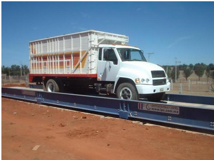
**Figura 18.** Báscula de pesado para camiones en ET.
