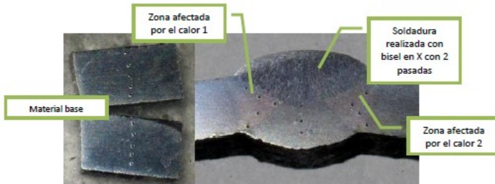
**Figura 28:** Probeta de la muestra 4 con las improntas de dureza Vickers en metal base, soldadura y ZAC.
