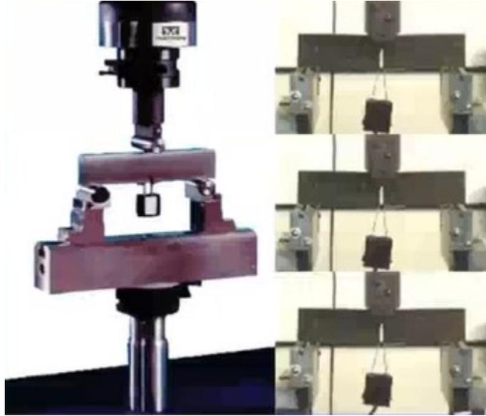
**Figura 36:** Colocación de la probeta de flexión en tres puntos en la máquina de ensayos con el clip gauge.
