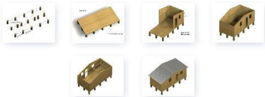
Figura 3.3-1. Pasos de construcción de la vivienda de emergencia de Un Techo Para Mi País
