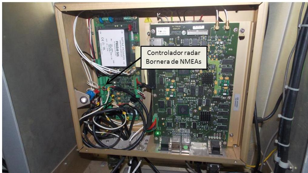
Ilustración 41 - Bornera de radar ARPA con interfaces NMEA
