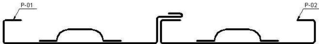
Figura 3.14. Vista de arriba de la sección transversal de las puertas tal como se encontrarían en el mueble con la alternativa A (no a escala).
