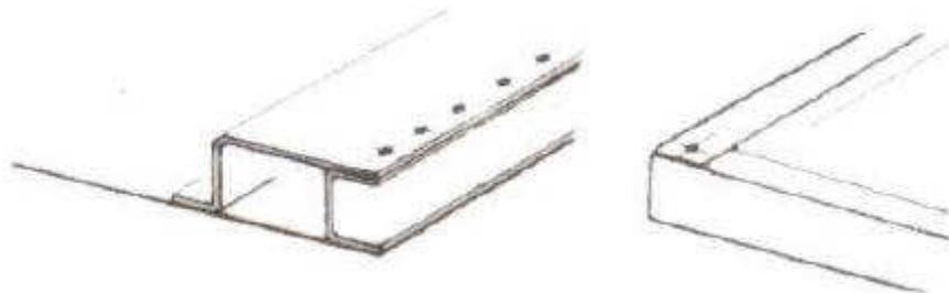
Figura 8.3: Ejemplos de soldaduras para las que se usan soldadoras pivotantes.
