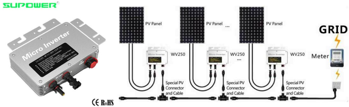
Figura 8-7: Microinversor WV250 y la instalación con cable BUS.
