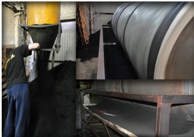
Figura 1 - 7. Descarga de tolva y clasificación de gránulos con zaranda rotativa
