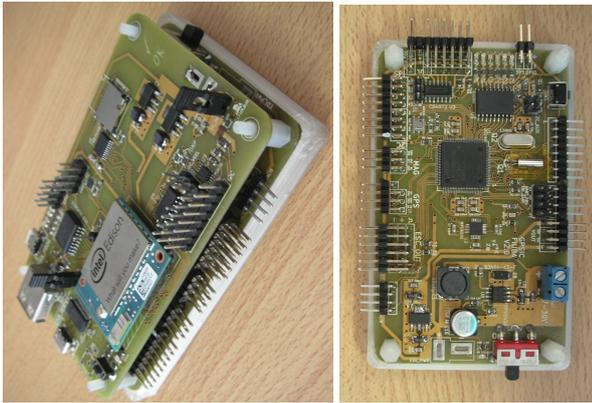
Figura 5: Computadora de navegación y control. Izquierda: Placa de alto nivel (Intel Edison). Derecha: Placa de bajo nivel (LPC-1769 y sensores de navegación).
