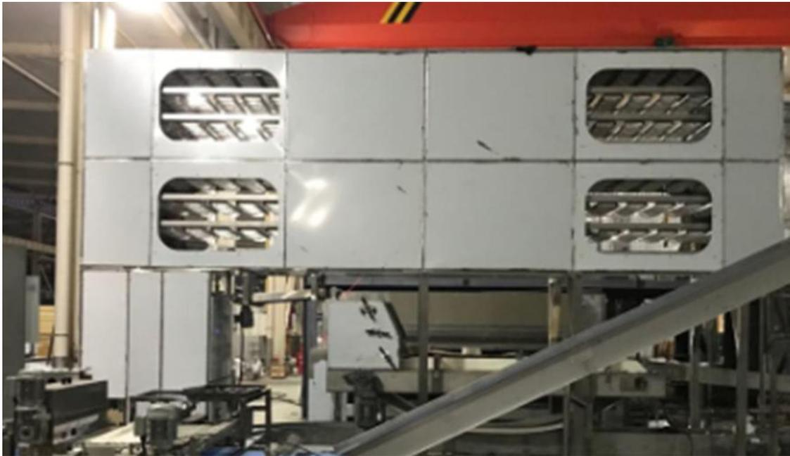
Figura 3-4. Fermentador intermedio con formadora marca AOCNO. Fuente: Hebei AOCNO Baking Machinery Co.
