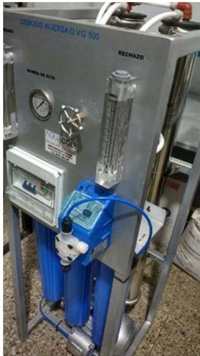
Figura 3-14. Máquina de osmosis inversa para tratamiento del agua para preparación de masa. Fuente: Hidrocol.
