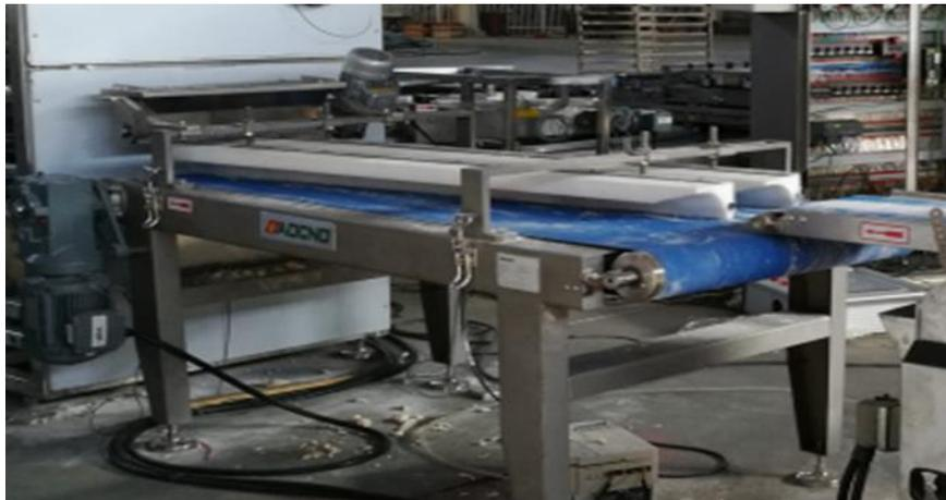
*Figura 3-3. Boleadora en cinta marca AOCNO. Fuente: Hebei AOCNO Baking Machinery Co.*
