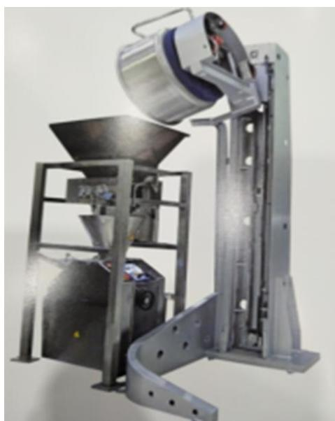
Figura 3-2. Cortadora en bollos automática con elevador de recipiente marca AOCNO. Fuente: Hebei AOCNO Baking Machinery Co.
