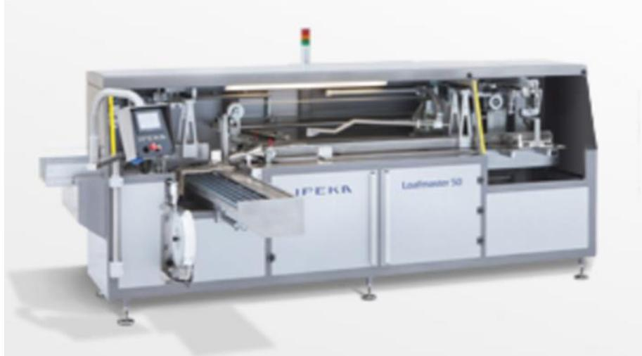
Figura 3-10. Envasadora automática con termosellado marca IPEKA modelo Loafmaster50. Fuente: Ipeka Automation Oy.
