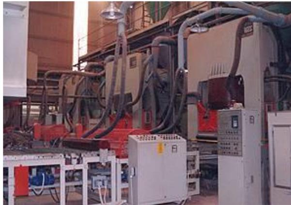
Figura 1.19: prensas hidráulicas
