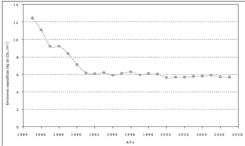
Figura 1.27: Evolución de las emisiones específicas de dióxido de carbono en la industria cerámica en España. Fuente: Bol. Soc. Esp. Ceram. V.
