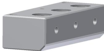
El bloque 1 es una pieza de aluminio mecanizado. Al igual que el brazo donde se colocan los vaporizadores y todas las piezas mecanizadas que posee la máquina, esta se tercerizará a un centro de mecanizado local.
