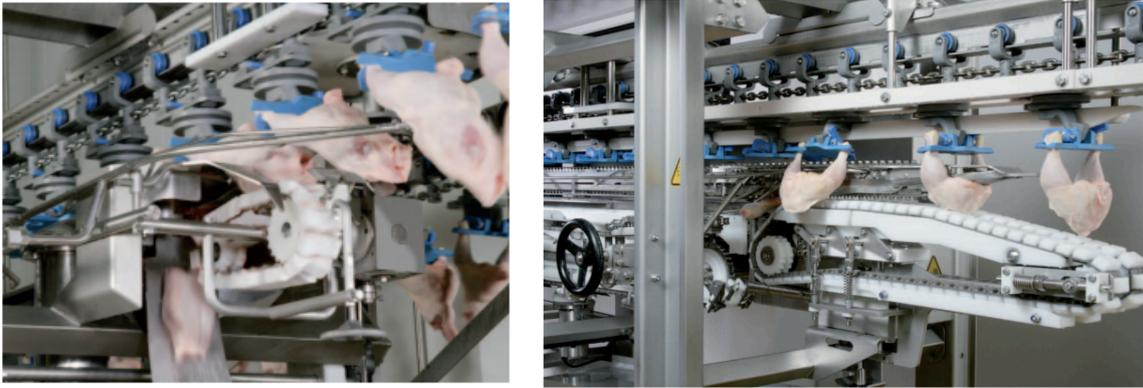
Figura 2.2.2.2. Procesado de parte delantera (izquierda) y parte trasera (derecha) realizado por una máquina troceadora.
