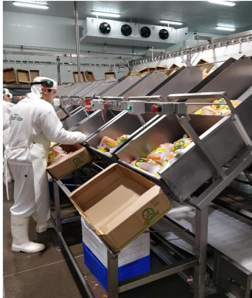
Figura 2.2.1.6. Proceso de pesaje para posterior embalaje de pollo entero en Que Rico S.A.
