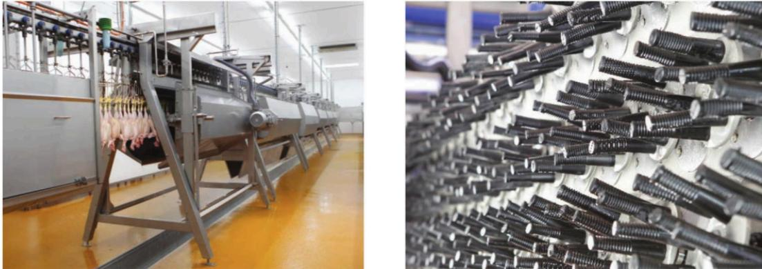
Figura 2.2.1.3. Desplumadora automática (izquierda) y “dedos” que remueven las plumas (derecha).
