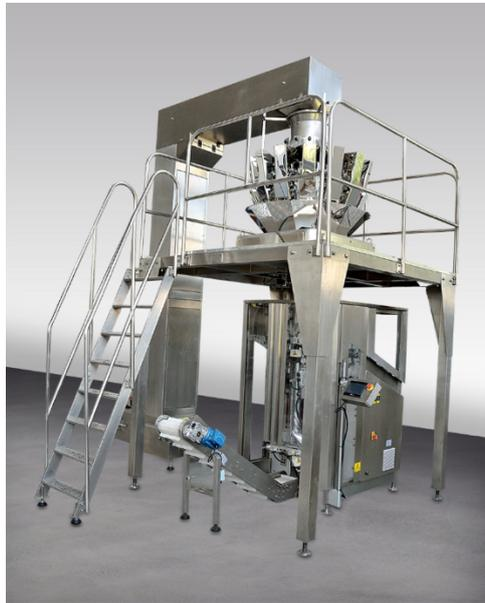
Figura 2.3.3.5. Envasadora vertical con pesaje multicabezal de Ulma.
