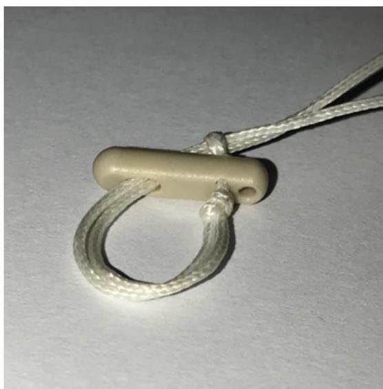
Figura 57: Vista desde abajo del prototipo de dimensiones reales fabricado por el mecanizador, ensamblado con las suturas correspondientes.
