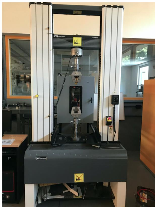
Figura 65: Equipamiento marca Instron, para realizar ensayos de tracción
