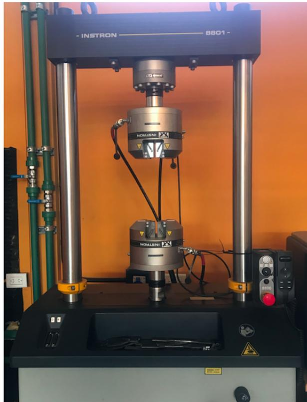
Figura 66: Equipamiento marca Instron con el cual se realizan ensayos de fatiga
