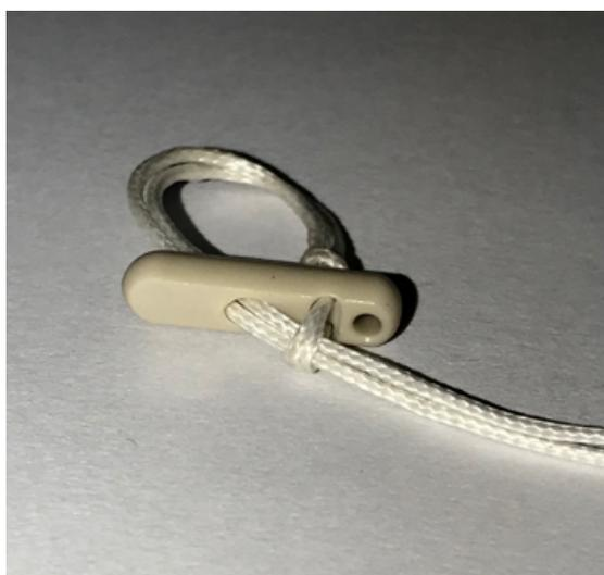
Figura 56: Vista desde arriba del prototipo de dimensiones reales fabricado por el mecanizador, ensamblado con las suturas correspondientes.
