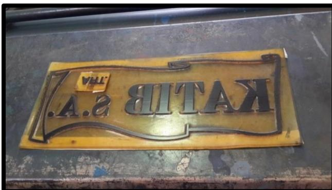
**Foto 2.10: Troquel:** Un ejemplo de un troquel fuera de uso. Se puede ver la complejidad de los cortes finales
