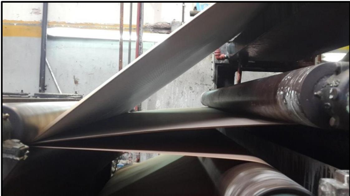
**Foto 2.4: Colero.** En este caso se muestra la conformación de un “triple faz”. En la imagen se observan las tres líneas correspondientes a las dos hojas simple faz y el *liner* (debajo).
