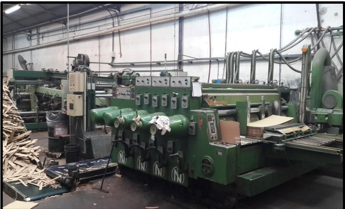
***Foto 2.12 Terminadora:*** Se puede ver como la máquina, más moderna, posee el proceso continuo de impresión, corte y pegado. A la izquierda se puede observar el desperdicio (*scrap*) luego de la etapa de corte. En la foto se pueden diferenciar cinco
