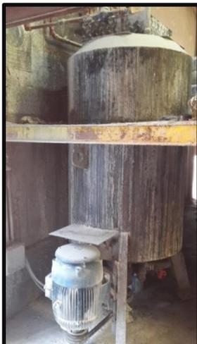
**Foto 2.1:** Tanque de mezcla para adhesivo (en la parte inferior se puede observar el motor de la bomba que se encarga de suministrar el fluido al tanque superior)
