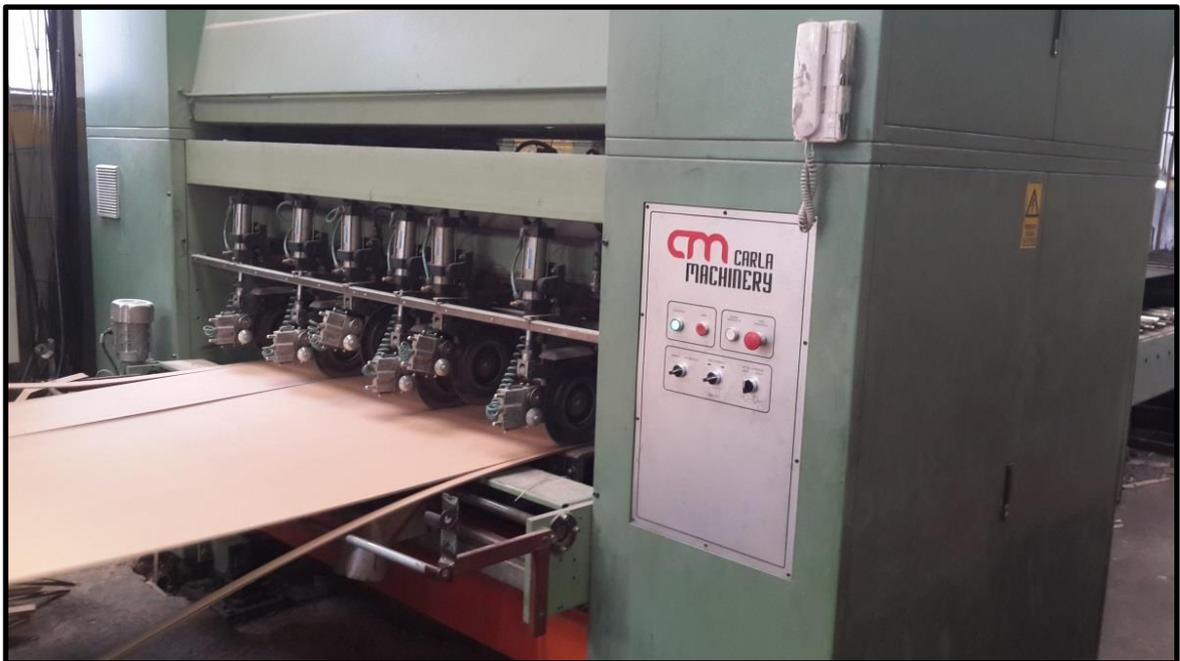
**Foto 2.6: Corte y Trazado.** Se puede observar en los laterales, el *scrap* que se genera luego de los cortes. Aunque imperceptibles en la imagen, el cartón además de los cortes posee trazados para sus posteriores pliegues.
