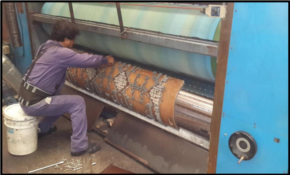
***Foto 2.11 Troqueladora:*** Se puede observar a un operario colocando un troquel en la troqueladora, las planchas de cartón pasan por entremedio de los rodillos, donde la presión de los mismos sobre el troquel logran imprimir la forma final.
