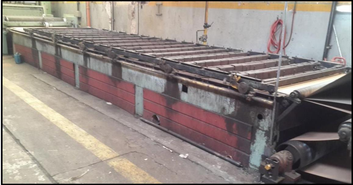
**Foto 2.5: Mesa de Secado.** La parte superior corresponde a las planchas de acero, estas no solo mantienen el calor uniforme en todo el cartón, sino que aplican cierta presión para ayudar a adherir las partes.
