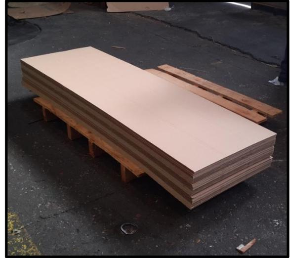
**Foto 2.7a y 2.7b: Cut-Off.** En la imagen de la izquierda se puede observar la plancha final de cartón corrugado. A la derecha la pila final de los planchones.
