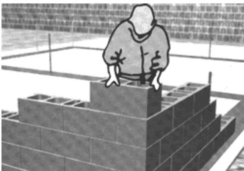
**Figura B.1** Elevación de hiladas en esquinas
