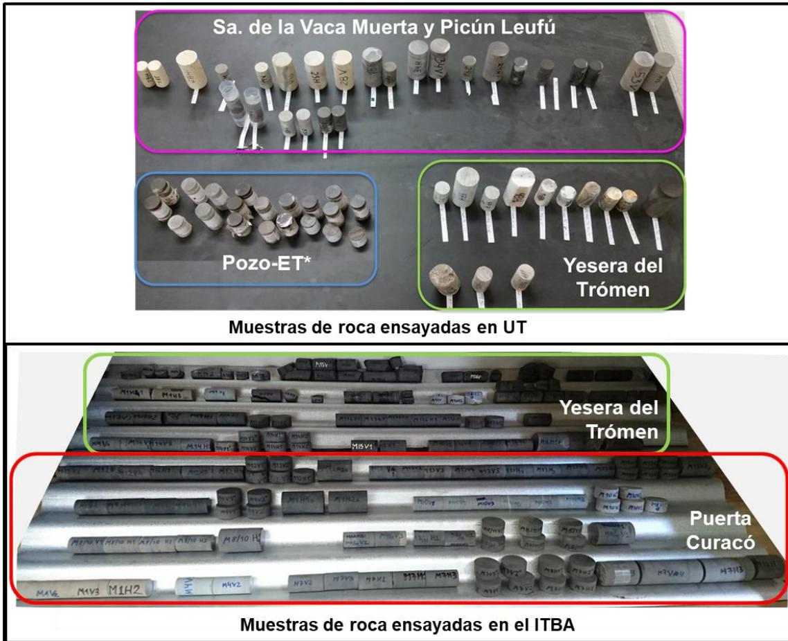
Figura 7.12: Fotografías de muestras de afloramiento y pozo listas para ser ensayadas mediante los diversos métodos.
