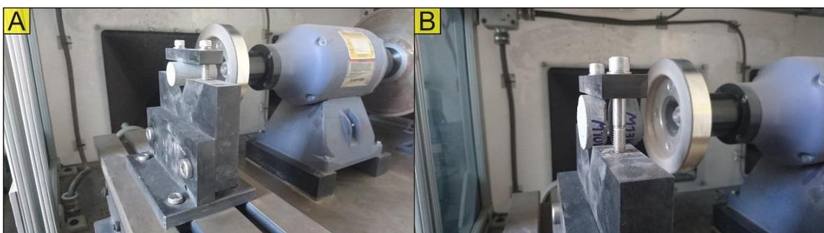
**Figura 7.4:** Mesa de trabajo de la pulidora. **A)** *Plug* de 1". **B)** *Plug* de 1,5".
