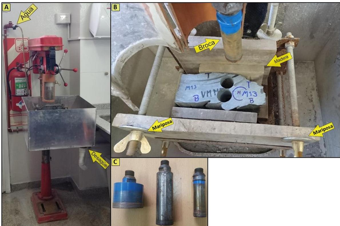
**Figura 7.1:** **A)** Taladro de columna K.L.D. modificado. Se pueden observar la campana de protección y captación de agua, el grifo para el agua, y el desagüe. **B)** Proceso de ubicación de muestra a extraer. Nótese la orientación de la muestra (con base B y techo T), y la ubicación aproximada del *plug* a extraer. Nótese el uso de maderas de apoyo, y las tuercas mariposa para el ajuste de la muestra. **C)** Detalle de las brocas de 1", 1,5" y 2,36".
