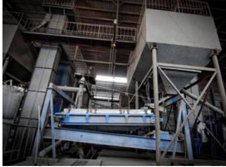
**Ilustración 20 - Línea para la clasificación y dosificación del *proppant* elaborado. Fuente: [toproppant.com](http://toproppant.com)**
