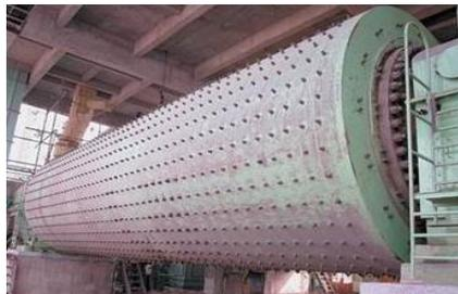
**Ilustración 16 – Vista externa de un molino de bolas en una fábrica de proppant. Fuente: [toproppant.com](http://toproppant.com)**
