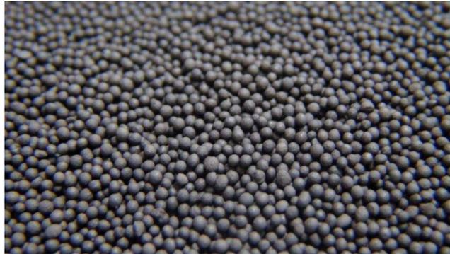
**Ilustración 13 - Proppant cerámico fabricado con alúmina en China proveniente de la empresa *Xinmi Wanli Industry Development Co.* Fuente: [tradekorea.com](http://tradekorea.com)**
