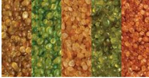
**Ilustración 12 - Arenas resinadas de diferente granulometría y proceso de curado. Fuente: *Momentive FracLine*, publicación de tecnologías relacionadas con la explotación de hidrocarburos.**
