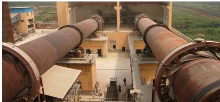
**Ilustración 19 - Horno de sinterizado. Como se aprecia sus dimensiones obligan a instalar los mismos fuera de la nave industrial. Fuente: [toproppant.com](http://toproppant.com)**
