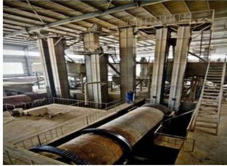
**Ilustración 18 - Sistema usado para el secado y tamizado de las partículas semielaboradas de proppant. Fuente: [toproppant.com](http://toproppant.com)**
