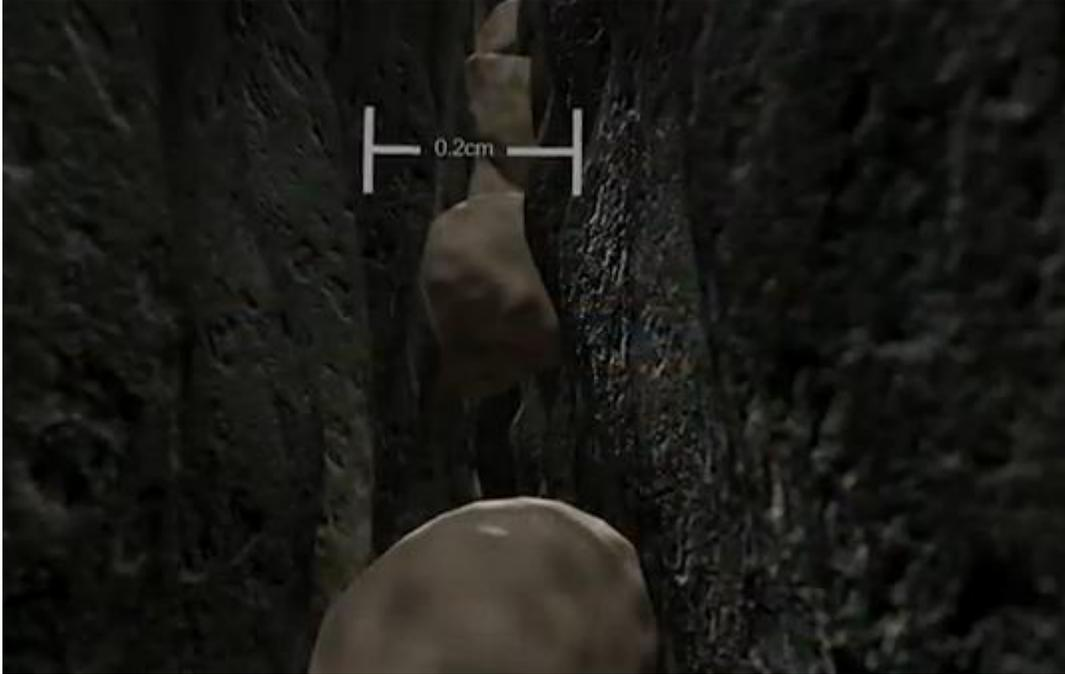
**Ilustración 5 - Animación del *proppant* en su función de agente de retención de las fisuras del *shale*. Fuente: *Marathon Oil Corporation***
