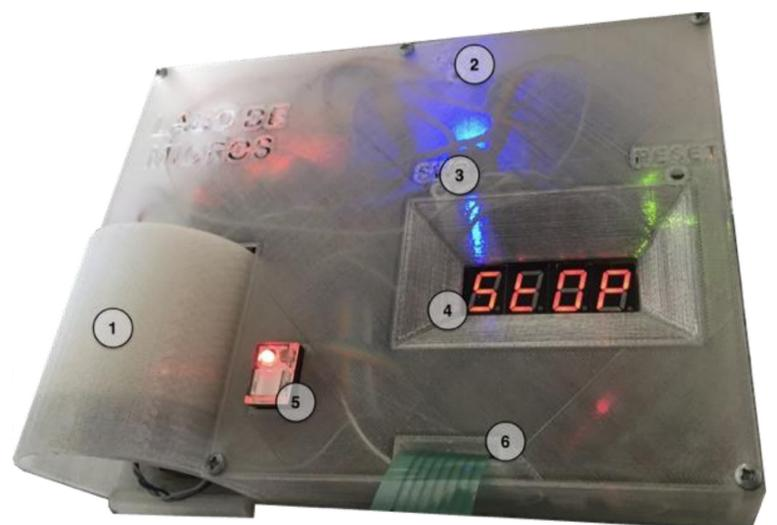
Figura 5: Captura de la estación. 1) Motor. 2) Botón intensidad del display. 3) Botón selector de información: RPM, RPS, Volt. 4) Pantalla. 5) Botón selector de dirección de giro. 6) Conexión de teclado.
