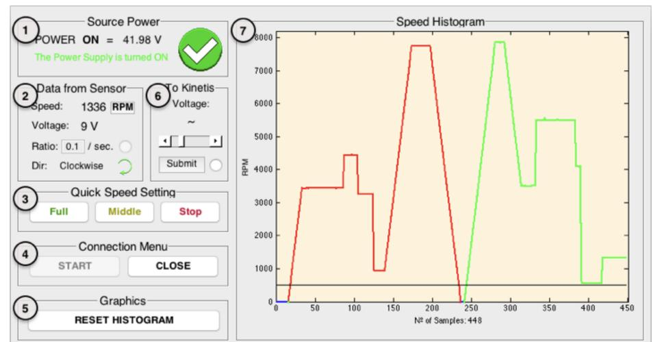
Figura 4: Captura del control de la terminal (MATLAB). 1) Control de tensión de alimentación. 2) Datos tomados del sensor. 3) Seteo rápido de velocidad: rápido, medio, parada. 4) Menú de conexión. 5) Reinicio del histograma. 6) Datos a enviar al motor. 7) Histograma de velocidades.
