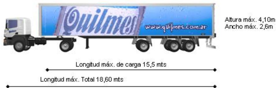
Figura 2.2-1: Camión del tipo sider utilizado por CMQ para las operaciones de acarreo.
