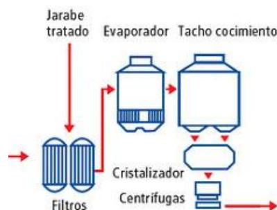
Ilustración 4. Refinado y Secado. (Tabacal, 2008)
