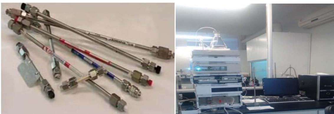
Figura 38. Diferentes columnas que contienen la fase fija (izq.). Vista completa del cromatógrafo (derecha)
