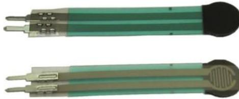
*Ilustración 6.10: Sensor de presión resistivo FSR-400*
