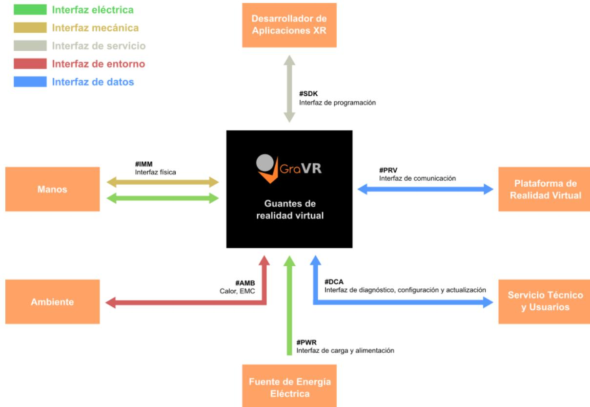
Ilustración 3.7: Diagrama Funcional de Interfaces
