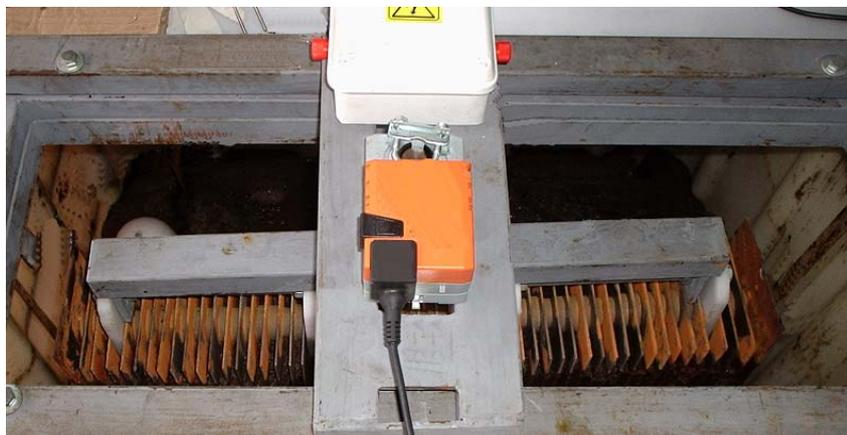
Figura 7. Reactor electrocoagulación
