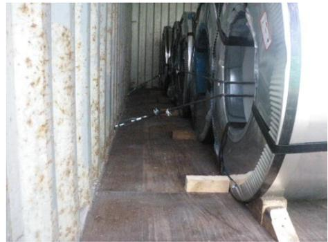
*Figura 2.5: Embalaje de bobinas*
