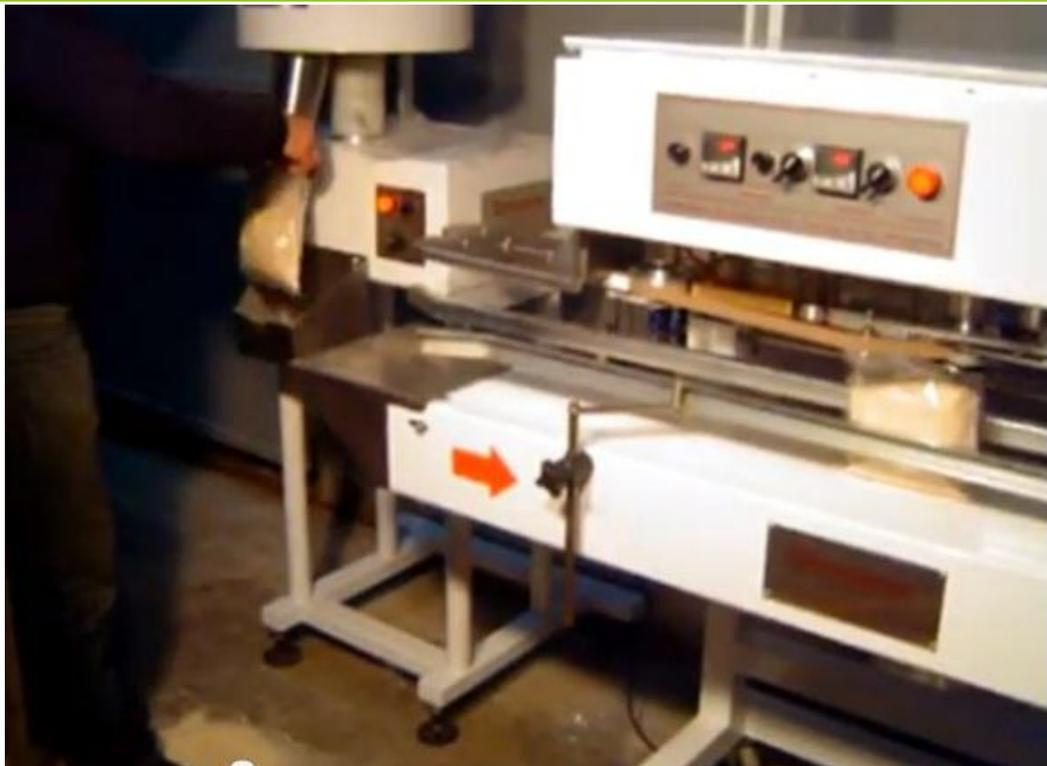
Ilustración 23. Proceso de dosificado y envasado manejado por un operario. Fuente: Envamar S.A.
