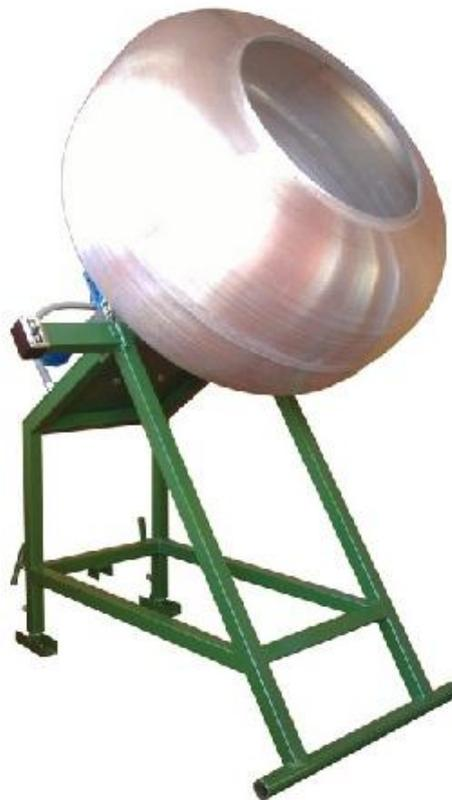
Ilustración 19. Máquina para revestir con chocolate las soynuts. Fuente: Trainingtec S.A.
