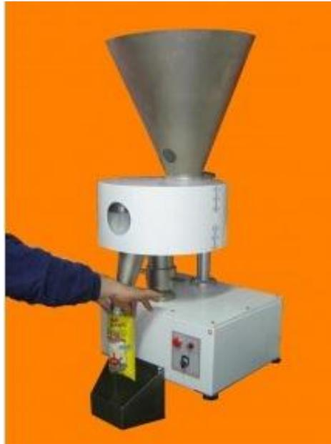
Ilustración 20. Máquina dosificadora volumétrica. Fuente: Envamar S.A.
