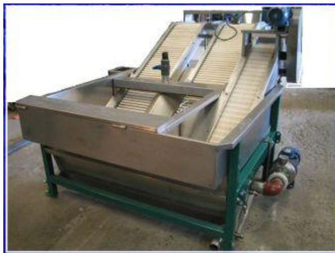
Ilustración 16. Tanque de volteo utilizado en el proceso de remojado. Fuente: Metalu S.A.
