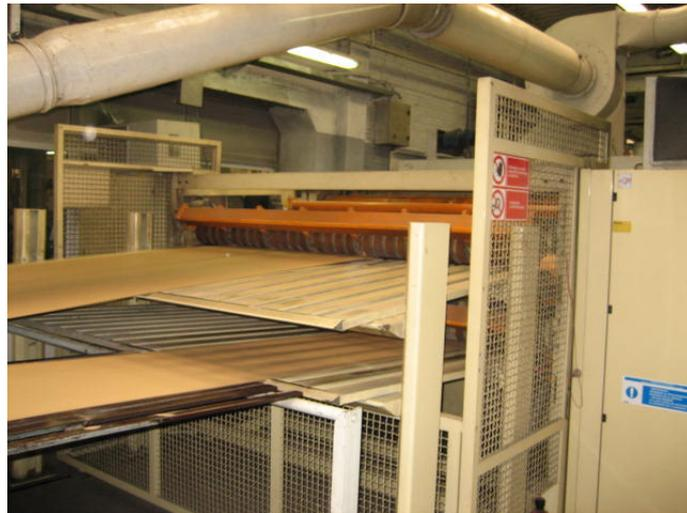
Salida del cartón ya cortado a medida y con los trazados de aleta
