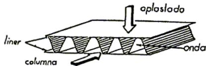
El cartón corrugado se produce en máquinas lineales de alta precisión llamadas corrugadoras corriendo a una velocidad de aproximadamente 200 mts por minuto. En las corrugadoras el papel es humidificado por vapor a alta presión. La humedad ayuda a suavizar las fibras del papel para ayudar a la formación de las ondas y el consiguiente pegado. Luego de la formación del cartón la humedad tiene que ser removida en el llamado dry-end de la corrugadora.
