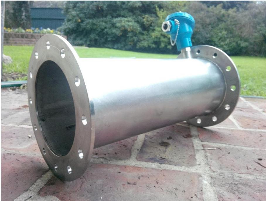
Figura 32: Ubicación de la termocupla a la salida de la cámara de combustión
