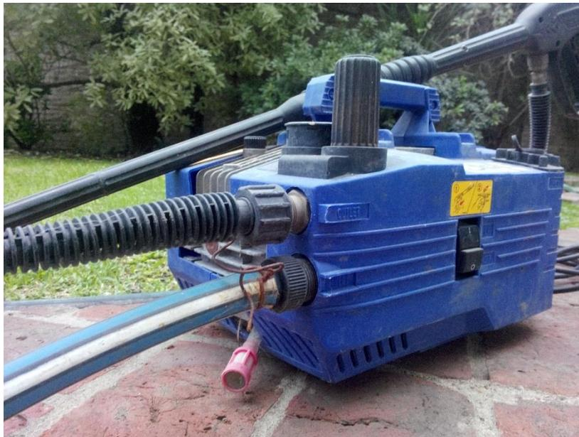
*Figura 37: Hidrolavadora utilizada para la inyección de agua*
