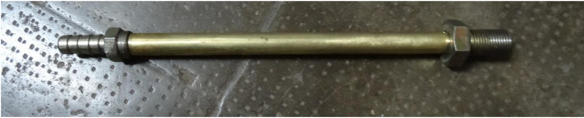
Figura 45: Cañería de aceite en la entrada del turbo
