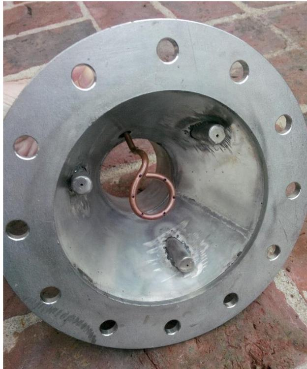
*Figura 24: Inyectores de agua e inyector de combustible, acero inoxidable y cobre*
