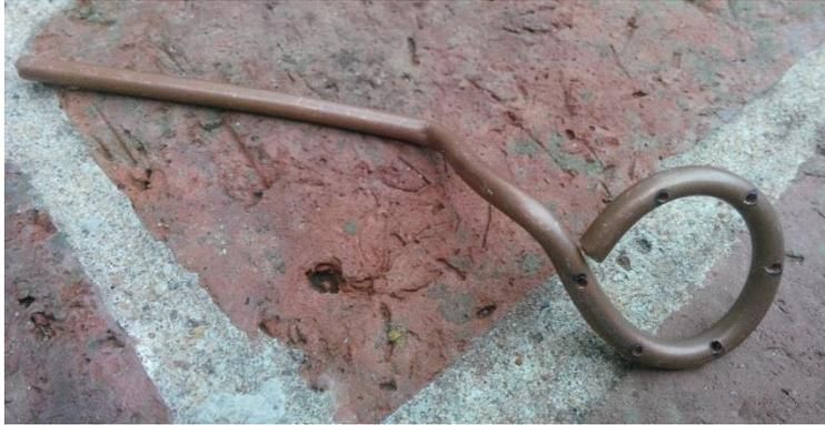
Figura 20: Fotografía del inyector de combustible, material: latón
