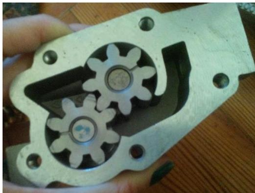
*Figura 42: Vista interior (engranajes) de la bomba de aceite*
