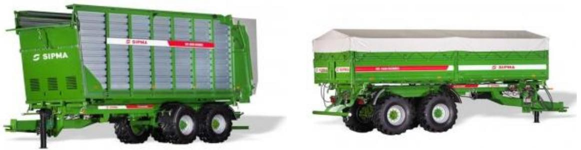
*Figura 5. 5 Carrocería tipo bañera (izquierda) y tipo caja (derecha).*
