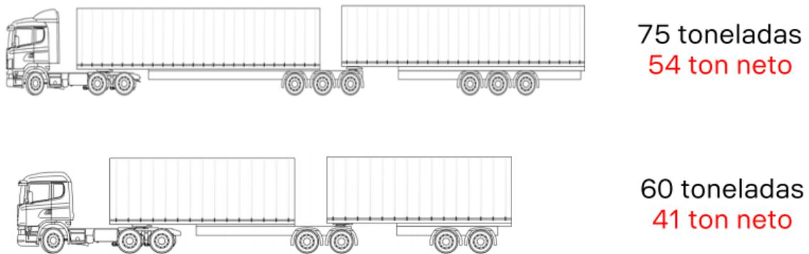
Figura 4. 28 Nuevos transportes de cargas utilizados con carga máxima neta posible. Scania.
