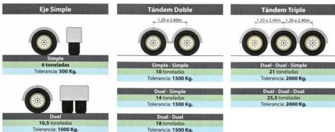
Figura 4. 29 Pesos máximos permitidos por eje y tolerancias. Aprocam.
