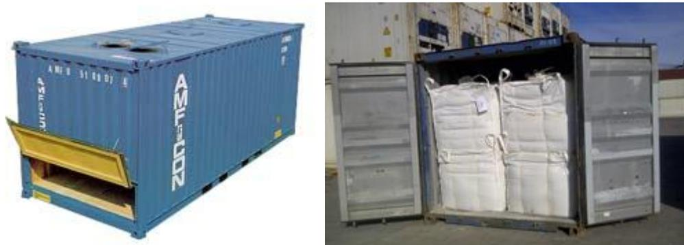
Figura 4. 8 A la izquierda, un contenedor granelero de 20 pies, a la derecha un contenedor seco cargado con Big Bags. TSP Patagonia Norte.
