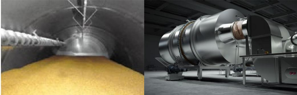
Figura 9.3. Vista interior y exterior del equipo de germinado.
