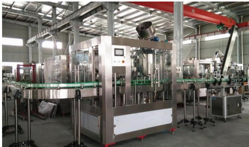
*Figura 9.12. Línea de llenado y embotellado.*
