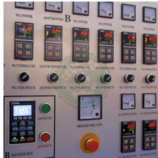
Figura 9.15. Sistema de control de T y P.
