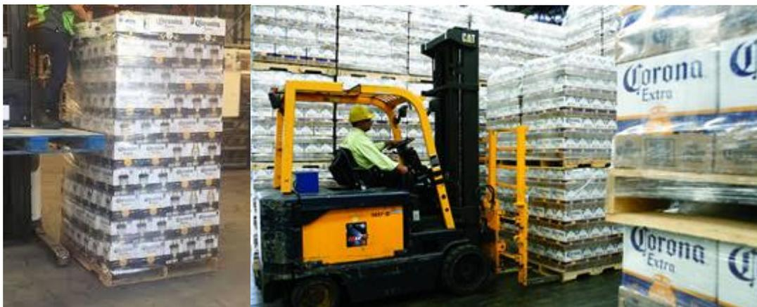
Figura 13.6. Paletizado de cajas de botellas y su transporte en autoelevador.
