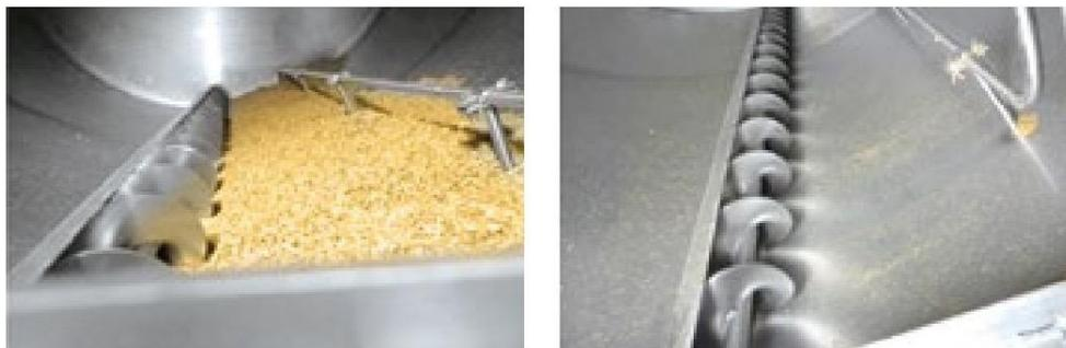
*Figura 9.6.* Tornillo sin fin interior del proceso de Desgerminado
