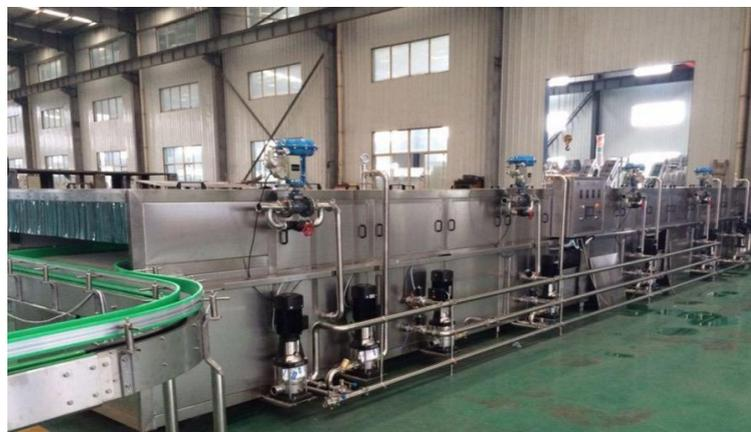
Figura 9.14. Sistema de pasteurización de botellas.
