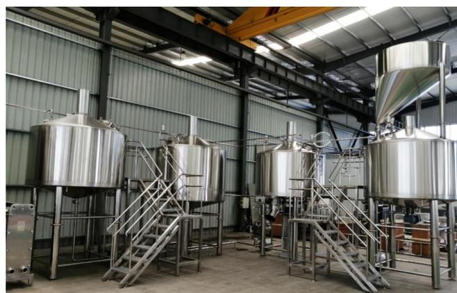
*Figura 9.10.* Configuración 4-Vessel de 5000 L/Batch en una planta standard
