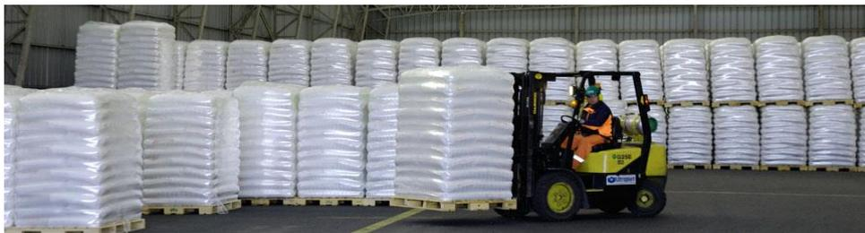
Figura 13.4. Paletizado de bolsas de 25 kg y su transporte en autoelevador.
