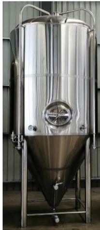
*Figura 9.11.* Fermentador cilindro-cónico cerrado standard.
