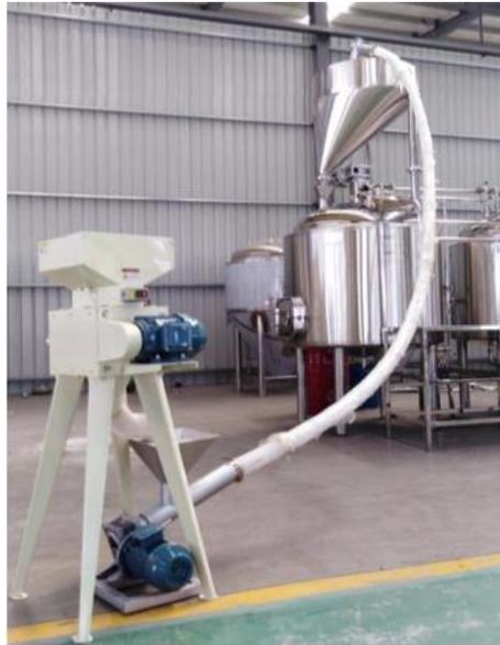
Figura 9.7. Proceso de molido y transporte de la malta a la cocción
