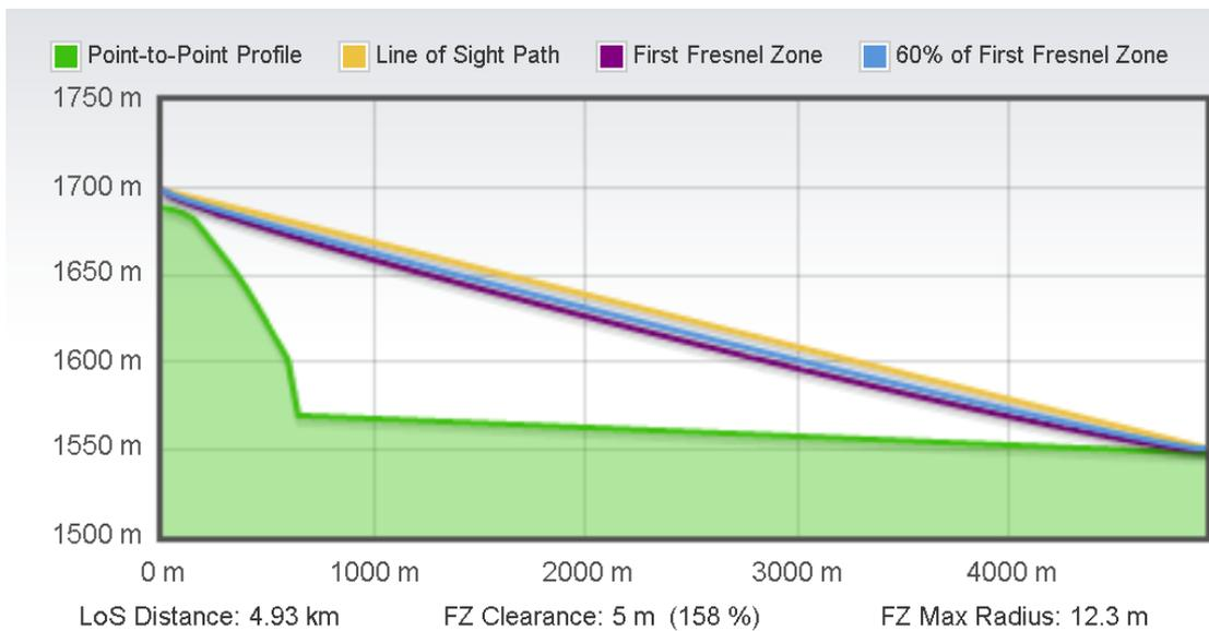
**Figura 4.5:** Enlace entre Coihueco y el tanque 1622 (Phil Collins). Se observa la ubicación en mapa tanto del coordinador en Coihueco como del suscriptor, el perfil del terreno entre ambos, así como también las diferentes zonas de Fresnel del enlace en cuestión.
