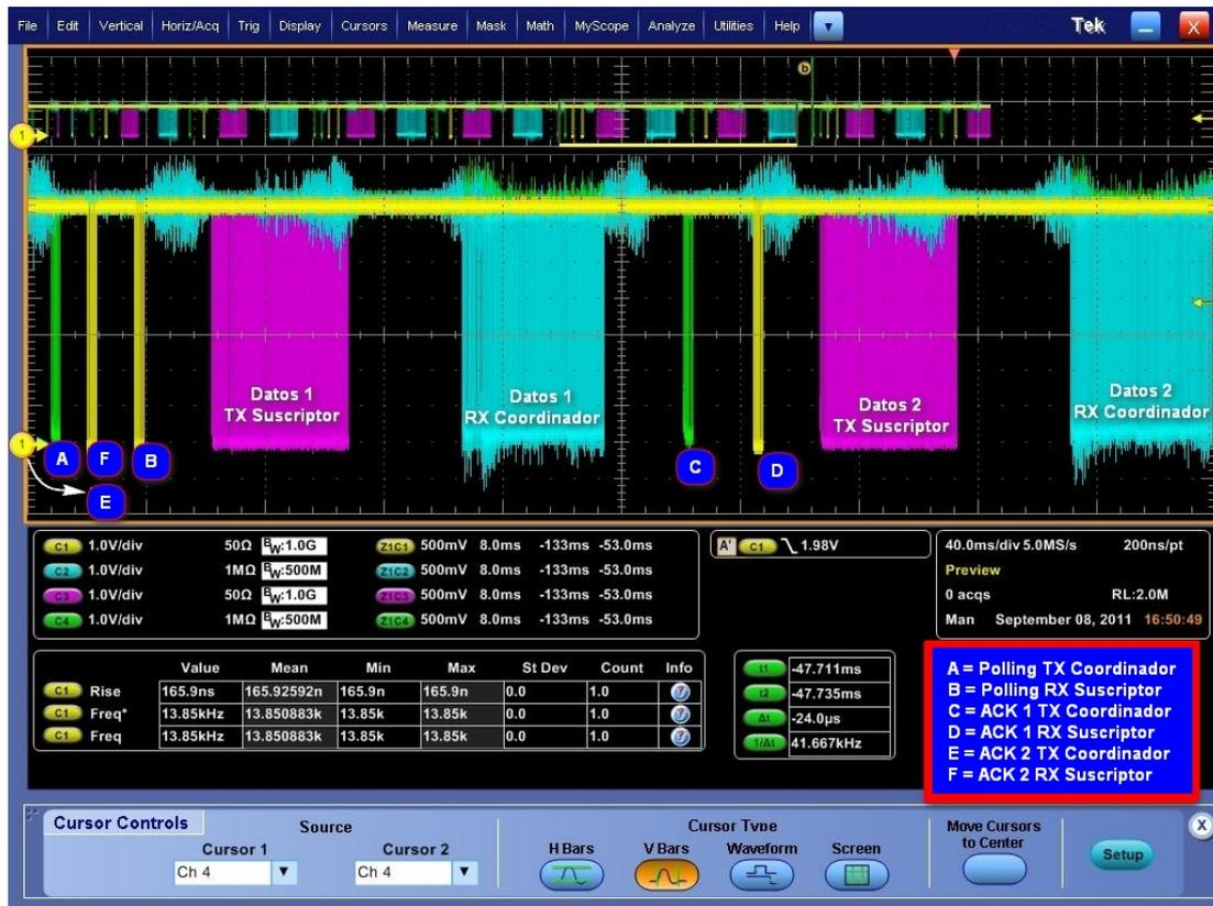
Figura 2.4: osciloscopio en RX y TX del coordinador y suscriptor
