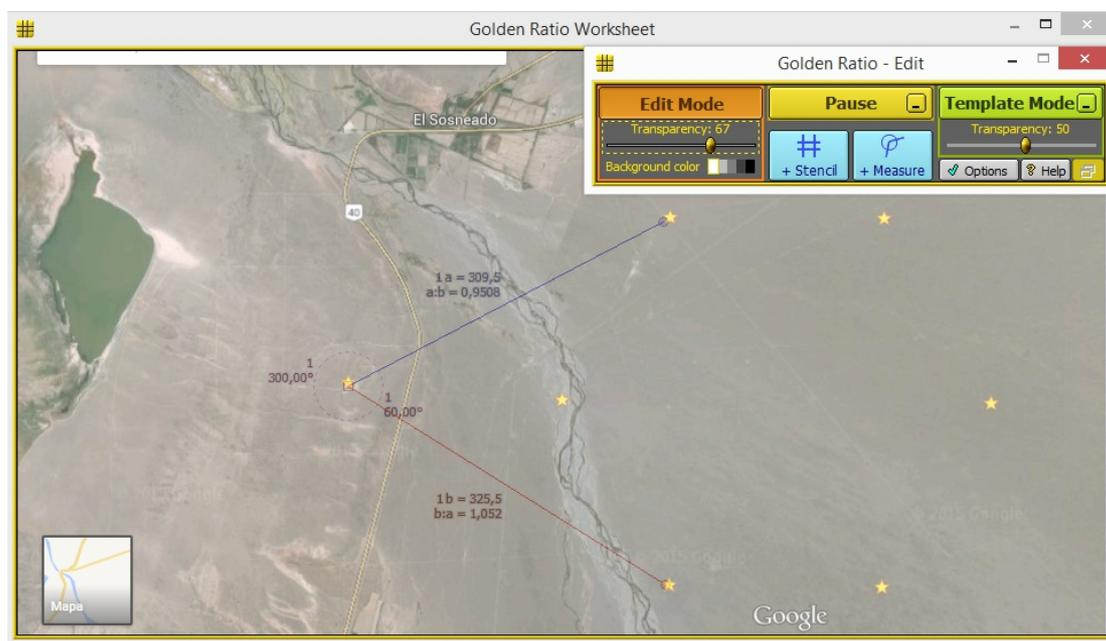
**Figura 3.1:** Cálculo del ángulo mínimo de apertura (60 grados) para la antena del equipo coordinador ubicado en Coihueco
