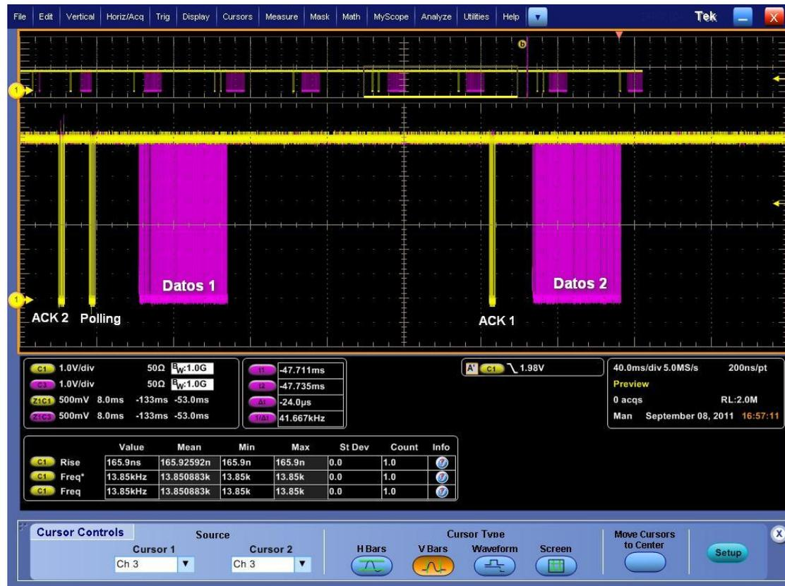
Figura 2.2: osciloscopio en RX y TX del suscriptor
