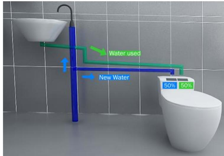
**Figura 5-92: Instalación para reutilizar agua.**
