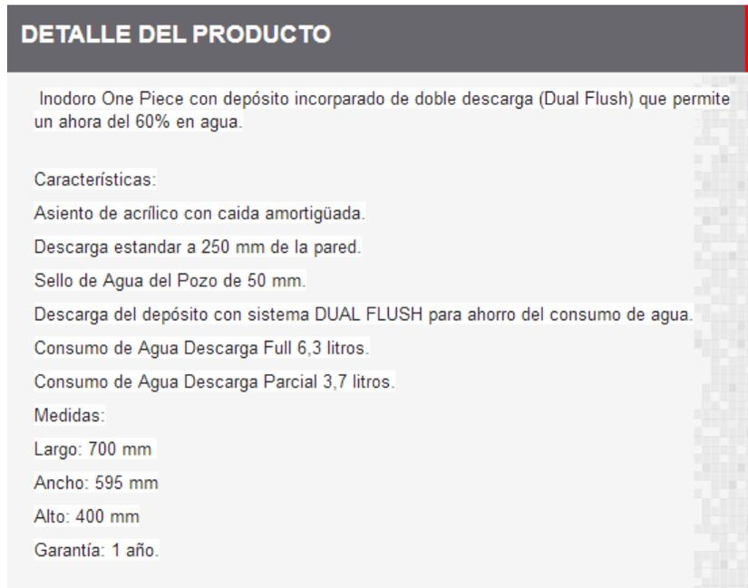
Figura 12-134: Datos técnicos del inodoro de doble descarga.
