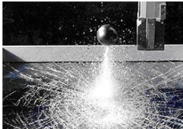
**Figura 5-86: Ensayo con vidrio laminado.**
