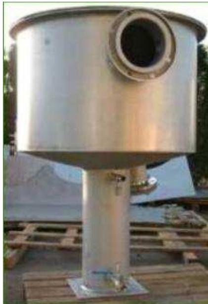
*Figura 21: Filtro de eliminación de condensados. Fuente: Aqualimpia.*
