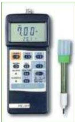
*Figura 10: Multímetro medidor de pH, Temperatura y Humedad. Fuente: Mercado libre.*
