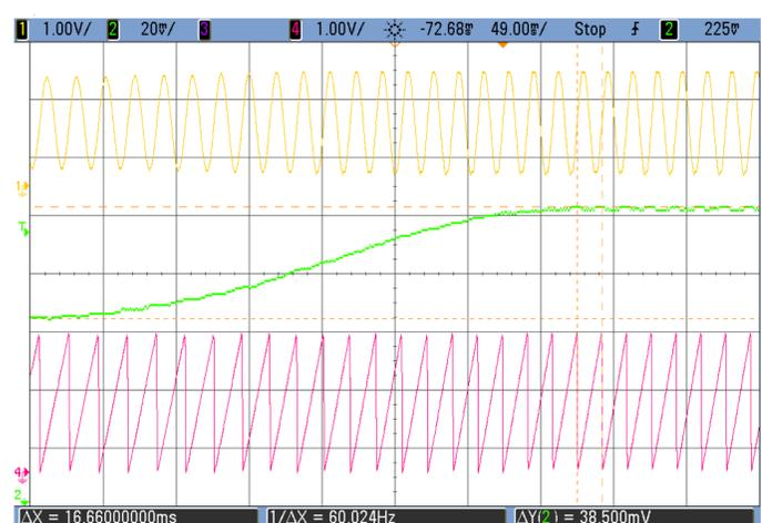
Figura 4: Respuesta frente a un escalón de frecuencia
