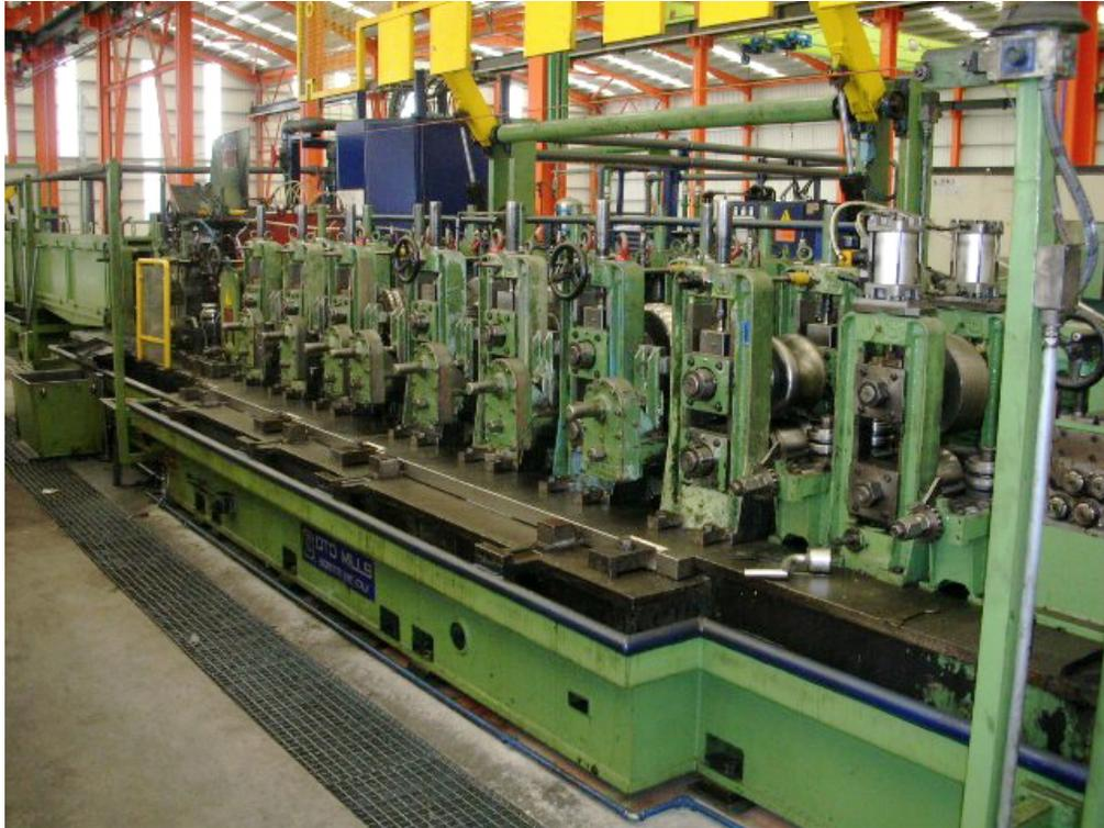
Figura 2: Máquina para conformado de tubos. Se observan los rodillos encargados de darle forma a la chapa.
