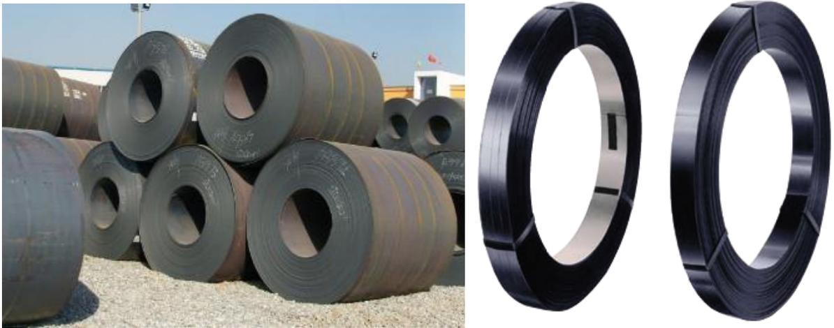
Figura 1: Bobinas (izquierda) y flejes (derecha) de chapa
