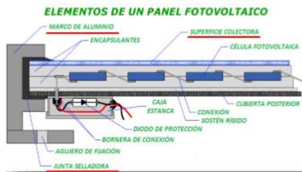
Ilustración 29 - Elementos del panel fotovoltaico y su estructura de soporte. Fuente: Presentaciones Energías Renovables, Segundo Cuatrimestre 2016, Instituto Tecnológico de Buenos Aires.
