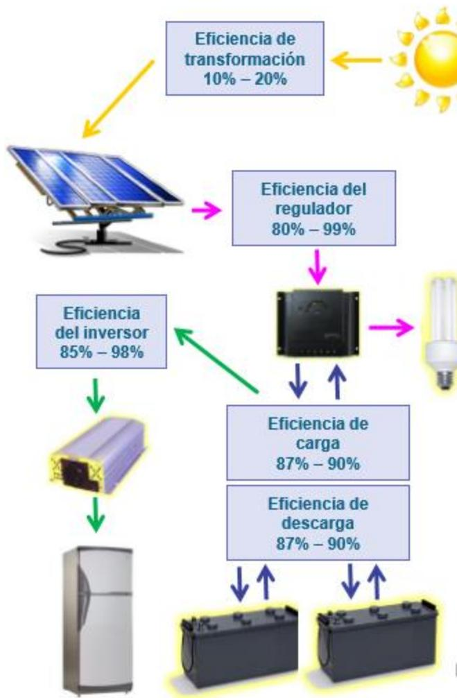
Ilustración 24 - Diagrama de pérdidas de un sistema de energías solares fotovoltaicas. Fuente: Presentaciones Energías Renovables, Segundo Cuatrimestre 2016, Instituto Tecnológico de Buenos Aires.
