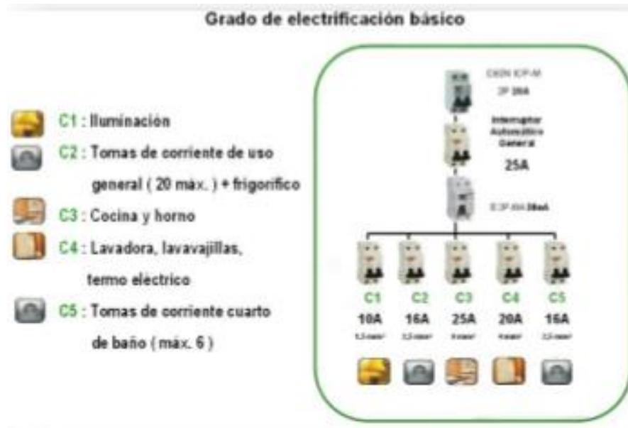
Ilustración 26 - Esquema de grado de electrificación básico. Fuente: Presentaciones Energías Renovables, Segundo Cuatrimestre 2016, Instituto Tecnológico de Buenos Aires.
