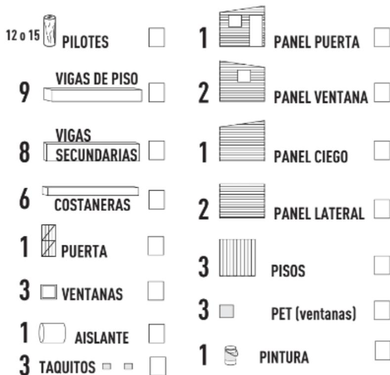
Ilustración 2 – Materiales que componen la vivienda de emergencia de TECHO. Fuente: manuales TECHO.
