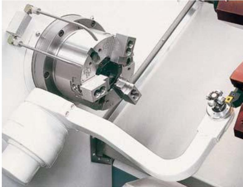
Fig. 4.7 – Seteador automático de herramientas<sup>35</sup>
