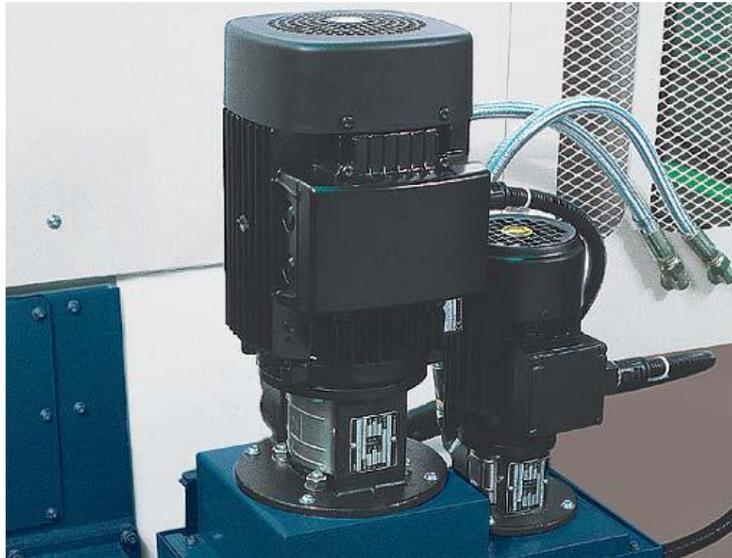
Fig. 4.13 – Sistema de bombas de alta presión en maquinas Romi
