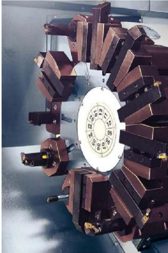
Fig. 4.6 – Torre porta herramientas de maquina Romi Modelo G30M<sup>22</sup>
