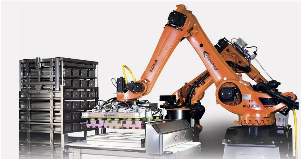
*Imagen 7.3.11-2: Robot complemento para desmoldeadora automática. (Fuente: Creminox<sup>52</sup>).*
