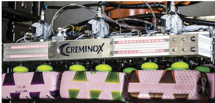
*Imagen 7.3.11-1: Desmoldeadora automática integrada a la torre de moldeo. (Fuente: Creminox<sup>51</sup>)*
