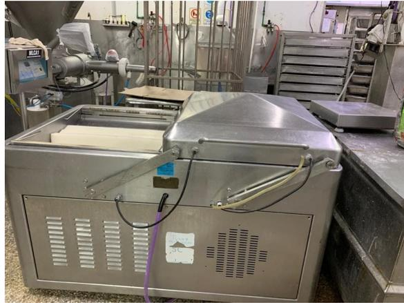
*Imagen 7.3.7-3: Máquina de vacío.*
