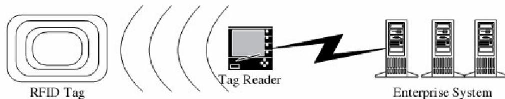
Figura 2. 6: Comunicación de etiquetas RFID con lectores y sistemas informáticos
