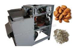
Dicha máquina posee una boca de entrada, en donde se introducen las almendras mojadas, y las mismas pasan luego por unas cintas de goma giratorias que frotan las almendras y retiran la piel sin romperlas. La máquina peladora de almendras es producida en China por *Amisy Machinery*. A continuación, se presentan datos técnicos
