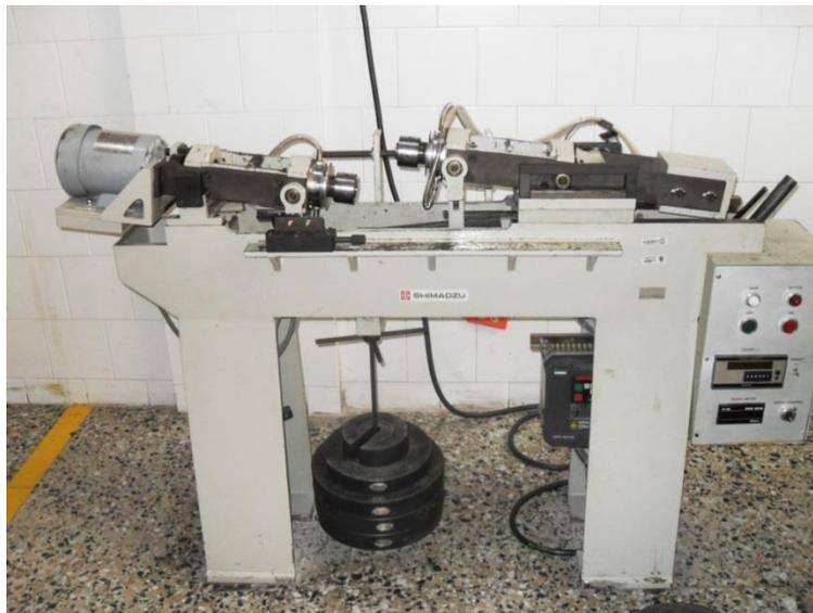
*Figura 5: Máquina de Moore construida por Shimadzu, donde se ve la ubicación de pesas para regular la carga aplicada a la probeta.*
