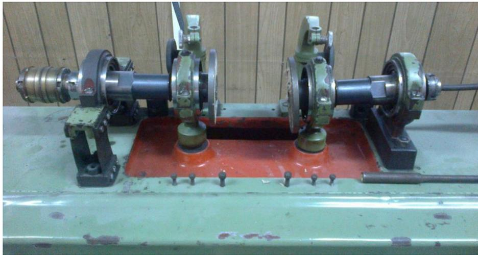
*Figura 9: Conjunto de semiejes en máquina Schenck PUPN relevada.*
