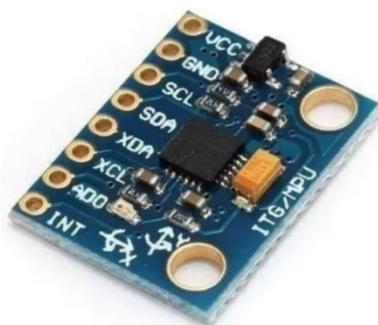
Figura 66 Módulo MPU6050 a utilizar
